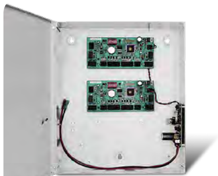
URC-2004... incluye dos controladores URC-2000, gabinete con fuente de poder.
